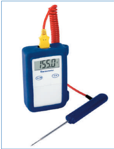
الشكل 38-1: المزدوج الحراري.
