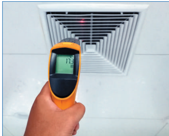
الشكل 1-40: مقياس الحرارة الإشعاعي.
