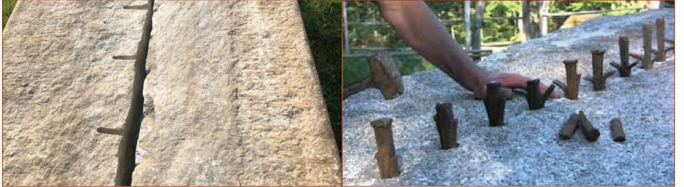
الشكل 2-14 شقّ الصخور بالأوتاد الخشبية المبلّلة بالماء.
