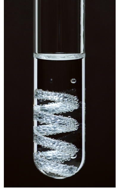
الشكل (9): تفاعل Mg مع حمض HCl المخفف.
