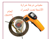
الشكل 14-1 يستخدم جهاز قياس درجة الحرارة بالأشعة تحت الحمراء لقياس درجة الانصهار.
