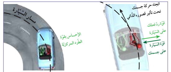
الشكل 2-4 تصوّر قوة الطرد المركزي.
