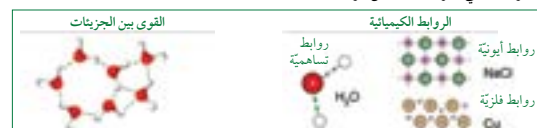
شكل 10-1 تعمل كل من الروابط الكيميائية والقوى بين الجزيئات على الإسكاف بجزيئات المادة معاً، الروابط الكيميائية أقوى.
