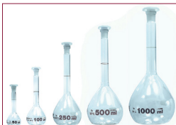
الشكل 39-2: تتوفّر الدورق الحجمية بسعات مختلفة.
