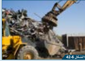
الشكل 42-6 تستخدم المغناط الكهربائيّة في إعادة التدوير، وهي قابلة لإعادة التدوير.
