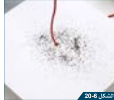
الشكل 20-6 المجال المغناطيسي الناتج من سلك يحمل تياراً كهربائياً.
