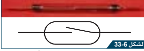
الشكل 33-6 مفتاح ذو الاتجاهين يحتوي على شريطيّين فلزيّين، يكونان غير مُتلامسين في الوضع العادي.
