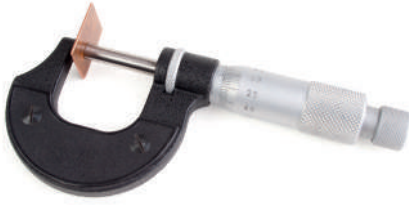
الشكل (3): قياس سُمْكِ صَفِيحَةٍ باستخدام الميكروميتر.
