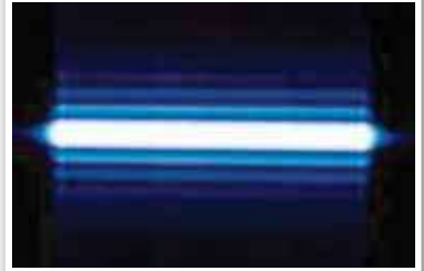
الشكل (37): تكوّن نمط من الأهداب المضيئة والمعتمة على حاجز، نتيجة ظاهرة الحيود.
