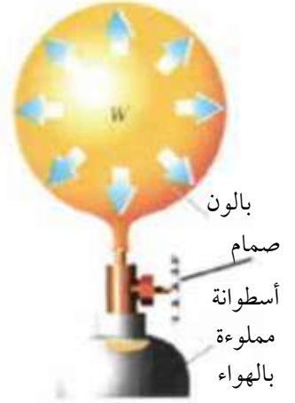
الشكل (29): تنخفض الطاقة الداخلية للهواء في البالون والأسطوانة مع تمدّده السريع؛ إذ يبذل الهواء شغلًا على المحيط الخارجي في أثناء تمدّد البالون.
