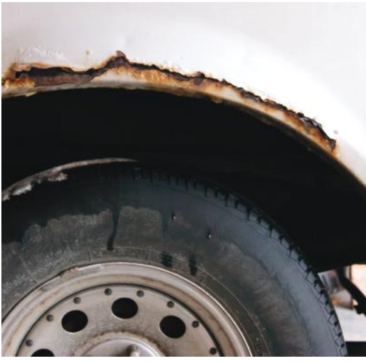
الشكل 9 تآكل هيكل هذه السيارة نتيجة تعرضه للماء الأكسجين. عند اختيار المواد، من الهام تقييم الظروف البيئية التي سيتم استخدام المادة فيها.
