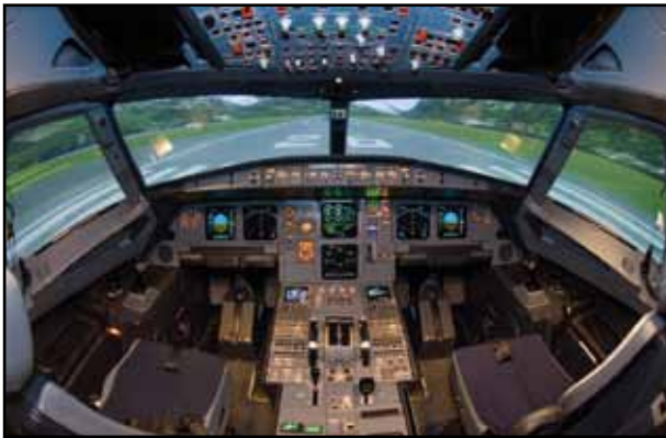
الشكل (١-٣): منظر داخلي لجهاز يُماثل غرفة القيادة في الطائرة.
