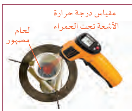
الشكل 1-14 يستخدم جهاز قياس درجة الحرارة بالأشعة تحت الحمراء لقياس درجة الانصهار.
