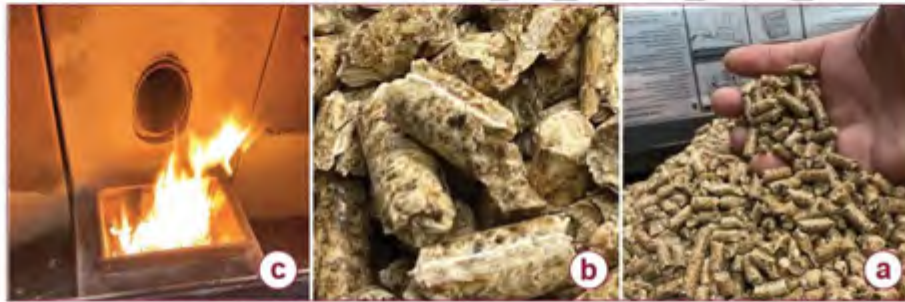
(a) وقود الحبيبات الخشبية، (b) نظرة عن قرب لهذا الوقود، (c) وعاء يحرق هذه الحبيبات الخشبية.
