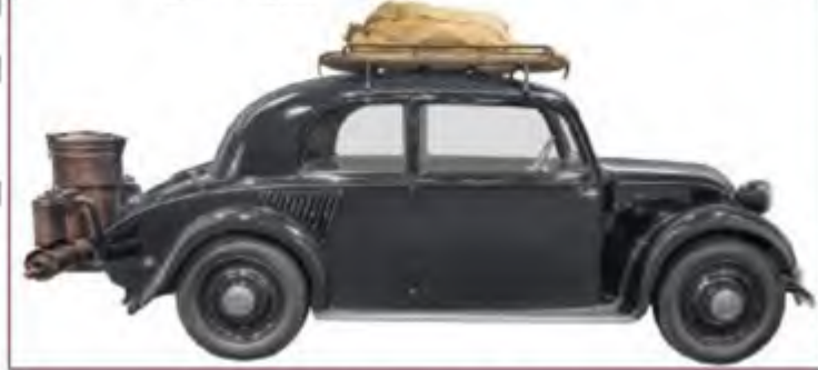
سيارة قديمة تم تصميمها لتعمل بالغاز المصنع الناتج عن الخشب.
