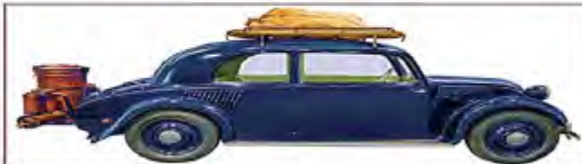
الشكل 6-17 سيارة قديمة تم تصميمها لتعمل بالغاز المصنع الناتج عن الخشب.
