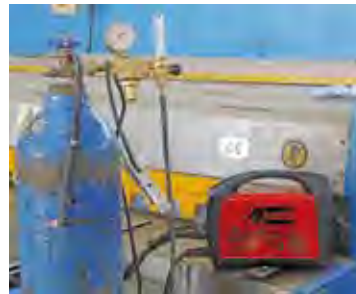
الشكل (٦-٦): آلة اللحام بقوس قطب التنجستون المحجوب بالغاز الخامل.
