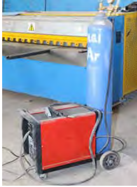
الشكل (٦-٥): آلة اللحام بالقوس الكهربائي المحجوب بالغاز الخامل.
