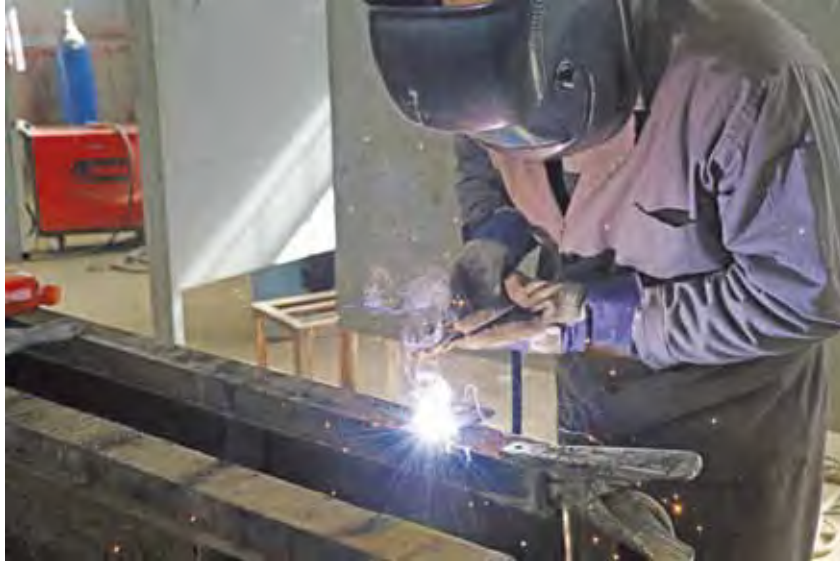
الشكل (٦-٣): اللحام بالقوس الكهربائي.
