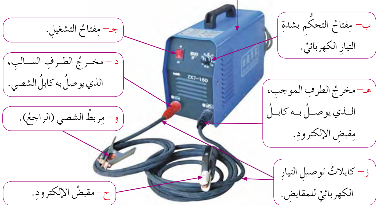
الشكل (٦-٨): آلة اللحام بالقوس الكهربائي المعدني اليدوي وأجزاؤها.
