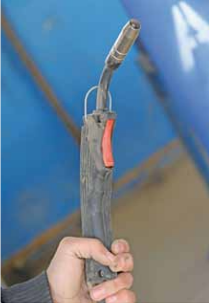
الشكل (٦-٥): آلة اللحام بالقوس الكهربائي المحجوب بالغاز الخامل.
