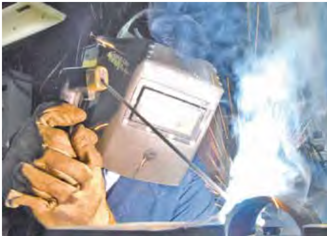
الشكل (٦-٤): آلة اللحام بالقوس الكهربائي المعدني اليدوي واستخدامها.
