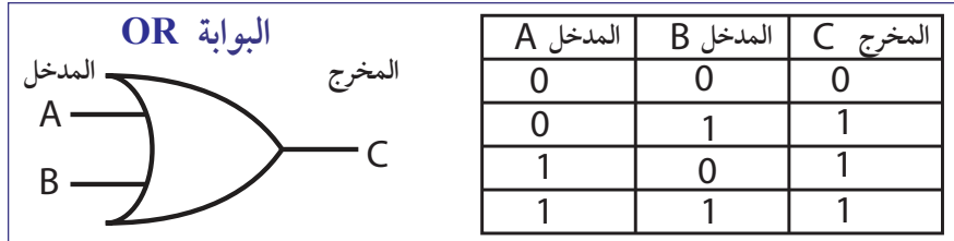
الشكل 4-52 رمز البوابة OR وجدول الحقيقة الخاص بها.
