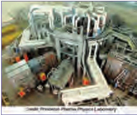
الشكل 7-31 مُفاعِل الاندماج النووي توكاماك.
