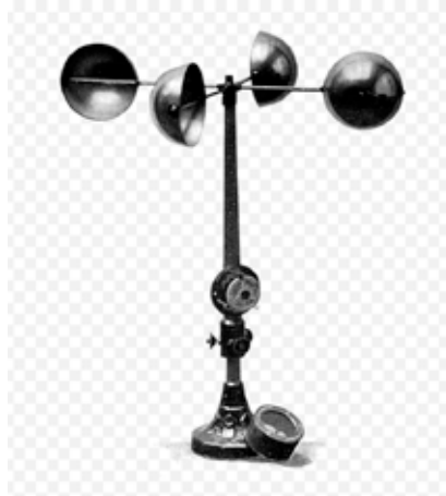
الأنيموميتر: يُستخدم لقياس سرعة الرّياح.
