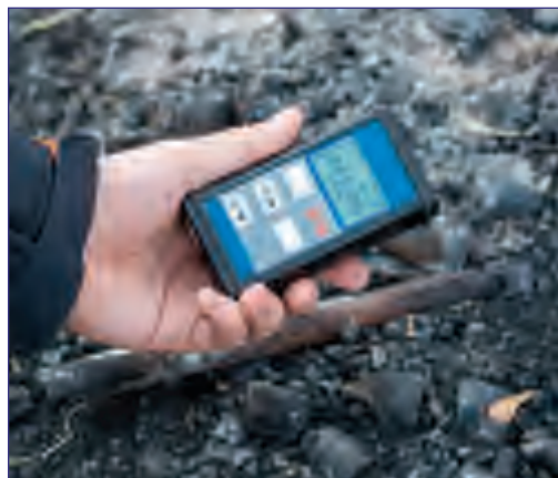
الشكل 23-7 عدّاد جيجر يكشف عن تسرّب في الأنبوب.
