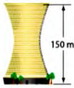
**التبريد** يتم بناء أبراج التبريد بتبارات الهواء الطبيعية على شكل قطوع زائدة للمزيد من كفاءة تبريد مصانع الطاقة. يمكن تمثيل القطع المكافئ للبرج الموضح بواسطة  $1 = \frac{x^2}{225} - \frac{y^2}{16}$ . حيث الوحدات بالمتر. أوجد عرض البرج عند القمة وعند أضيق نقطة في المنتصف.
