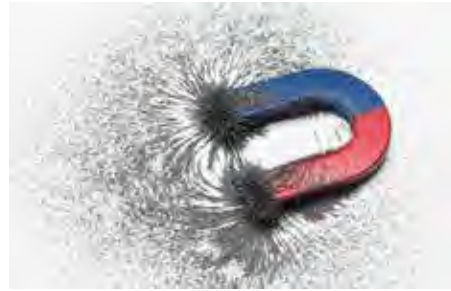
الشكل (1) تخطيط المجال المغناطيسي باستخدام برادة الحديد
