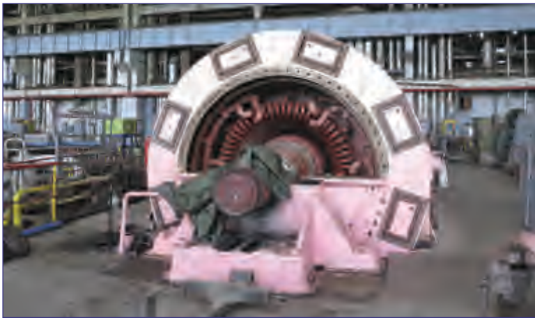
الشكل 22-5 مولّد كهربائي صناعي مفكّك للصيانة.
