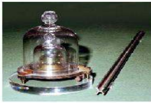
الشكل 6-1 : الوحدات المعيارية للكيلوجرام والمتر موضحة في الصورة ويصِف المتر المعيارى بأنه المسافة بين إشارتين على قضيب من البلاتينيوم والأيريديوم، ولما كانت طرق قياس الزمن أدق من طرق قياس الطول فإن المتر يصِف بأنه المسافة التي يقطعها الضوء في الضراع في \frac{1}{299792458} ثانية.
