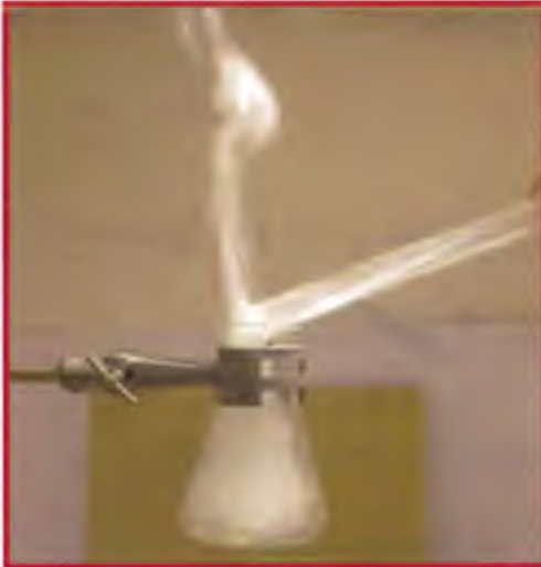
شكل (24-3): تقريب ساق مبللة بحمض الهيدروكلوريك من غاز الأمونيا وتكوين سحب بيضاء من كلوريد الأمونيوم \text{NH}_4\text{Cl}
