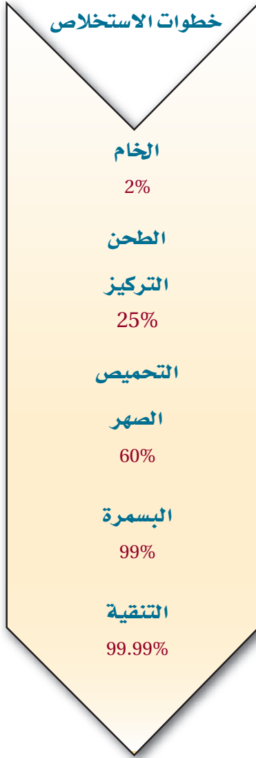
الشكل 35-6 خطوات استخلاص فلز النحاس.
