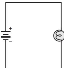
14. رسم تخطيطي ارسم رسمأً تخطيطياً لدائرة كهربائية تحتوي على بطارية ومصباح كهربائي، وتأكد من أن المصباح الكهربائي سيضئ في هذه الدائرة.
