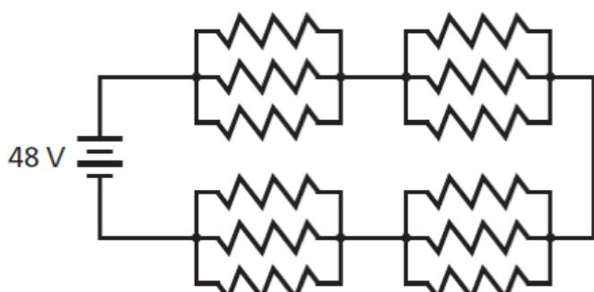
85. تطبيق المفاهيم صمم دائرة كهربائية يمكنها إضاءة 12 مصباح متماثلاً، بكمال شدتها الضوئية الصحيحة بواسطة بطارية جهدها 48 V، لكل حالة مما يلى:
