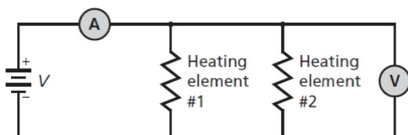
75. دائرة كهربائية منزلية يوضح الشكل 4-20 دائرة كهربائية منزلية، حيث مقاومة كل سلك من السلكين الواثلين إلى مصباح الطبخ 0.25 Ω، ومقاومة المصباح 0.24 kΩ. على الرغم من أن الدائرة هي دائرة توافر إلا أن مقاومة الأسلاك تتصل على التوالي بجميع عناصر الدائرة. أجب بما يلي:
