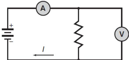
12. أضف فولتمتر إلى الرسم التخطيطي للدائرة الكهربائية في المسألة السابقة لقياس فرق الجهد بين طرفي المقاومين، ثم أعد حلها.
