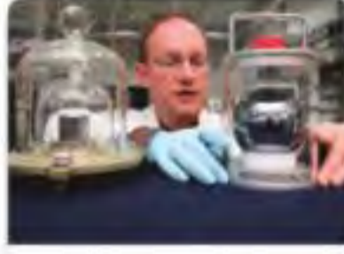
الشكل 2 يجري العلماء في المعهد الوطني للمعيار والتكنولوجيا تجارب لإعادة تعريف الكيلوجرام باستخدام جهاز تعرف ميزان الواط. ويستخدم ميزان الواط نتائجاً كهربيًا ونملاً متناهيًا لقياس القوة المطلوبة لوزن كتلة كيلوجرام واحد في معادل قوة الجاذبية. يسمي علماء آخرون عدد الذرات في كتلة الكيلوجرام الواحد إعادة تعريف الكيلوجرام.
