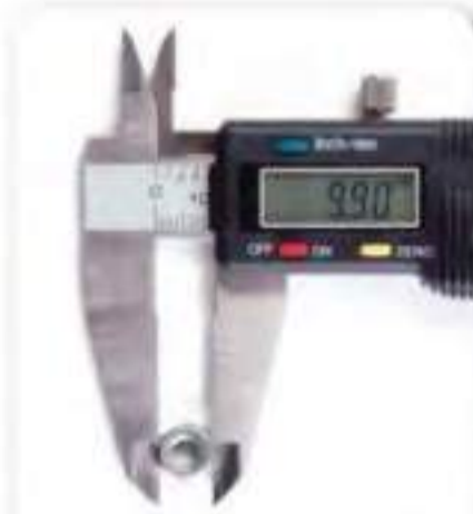
الشكل 11 يُستخدم المقياس العكسي الرقمي للتحقق من حجم صامولة حتى جزء من المئة من المليمتر (0.01 mm). إن الميزة المطلوبة لتحميد وضع الجزء في المقياس العكسي بسهولة صحيحة. سيحصل الميكانيكون أصحاب الخبرة على قراءات أكثر دقة من الميكانيكين غير الخبراء.
