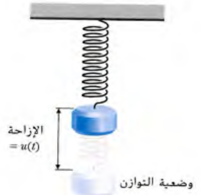
الشكل 3.32 نظام الزنبرك-الكتلة
