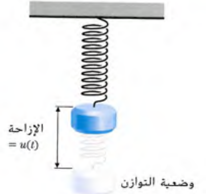
الشكل 3.25 نظام الزنبرك-الكتلة
