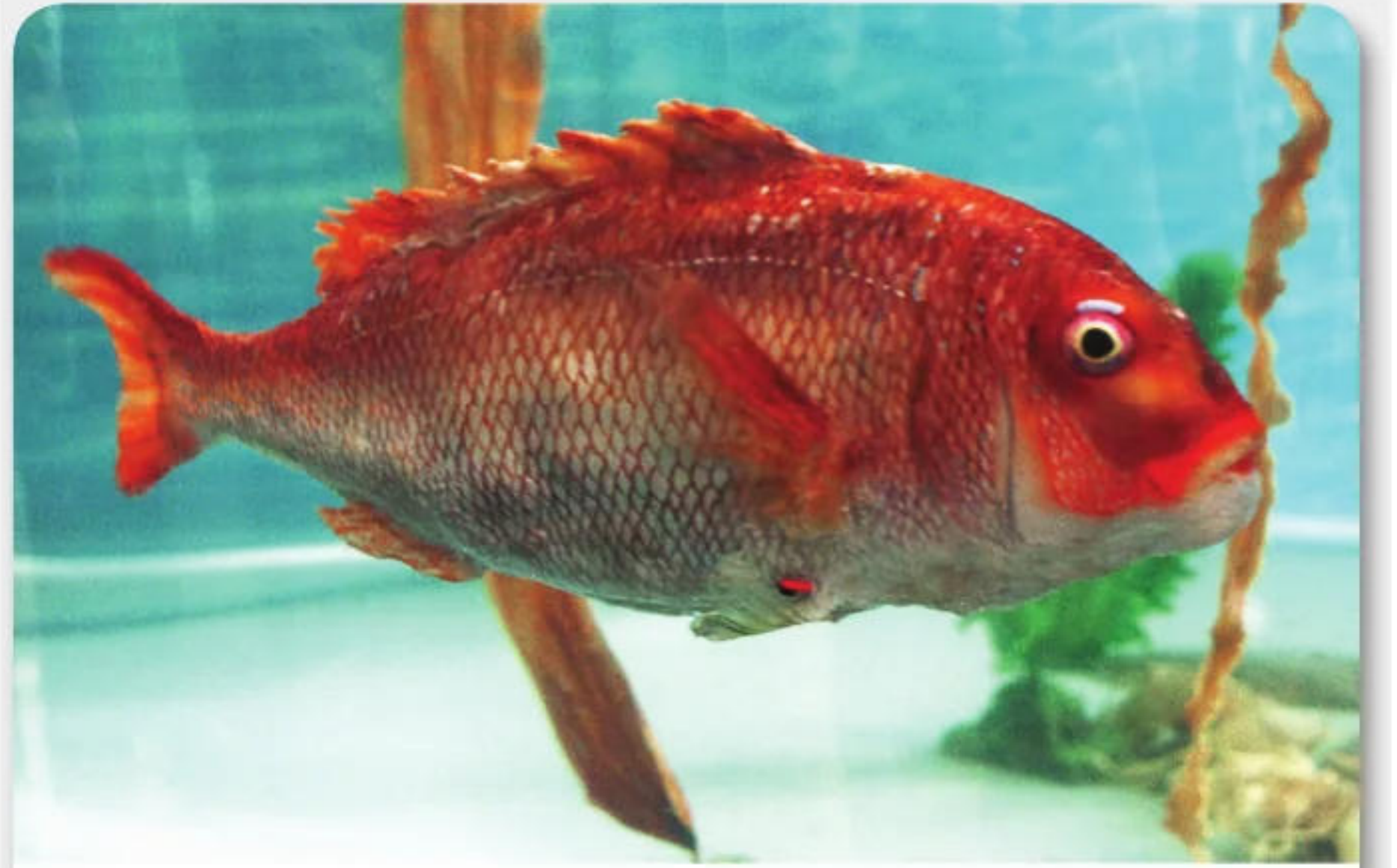
■ الشكل 6 أشأ العلماء الذين يطورون تقنية الغواصات هذا الروبوت الذي يشبه السمكة ويسبح مثلها. الهيكل مصنوع من راتينجات سيليكونية تصبح لينة في الماء.
