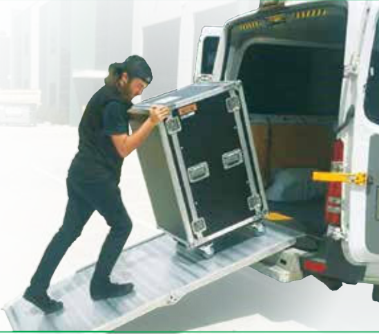
رفع الصندوق إلى أعلى يستدعي قوة أقل باستخدام المستوى المائل.
