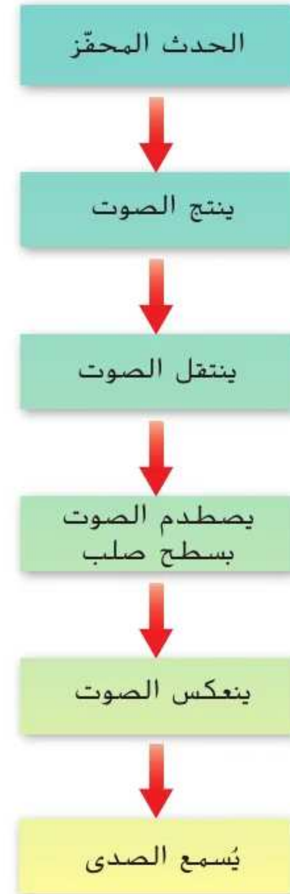
الشكل 4 تبين خرائط المفاهيم لسلسلة الأحداث ترتيب الخطوات المتبعة في عملية ما أو ترتيب الأحداث. تبين خريطة المفاهيم هذه كيفية توليد الصوت للصدى.
