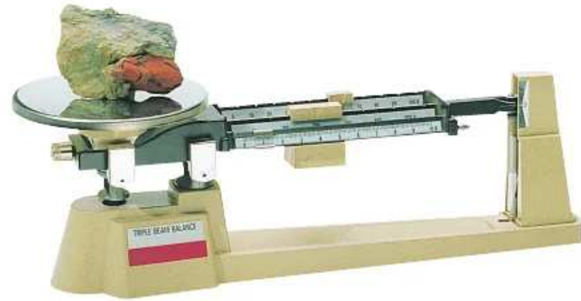
الشكل 11 يُستخدم الميزان ثلاثي الأذرع لتحديد كتلة جسم ما.
