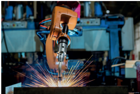
تنفيذ اللحام النقطي بالروبوت.
