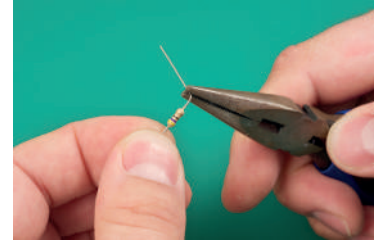
تشكيل المكونات مسبقاً قبل إدخالها في لوحة الدائرة.
