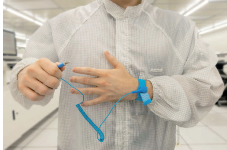
◀ سوار معصم نموذجي مقاوم للكهرباء الساكنة.
