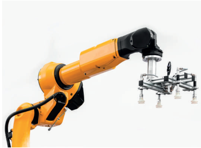
روبوت مزود بجهاز تثبيت متعددة الأدوات.
