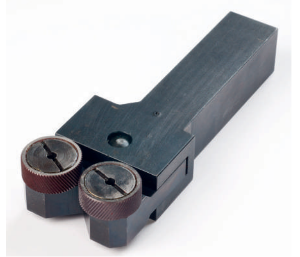
الشكل 3.12 تستخدم أدوات التخريش لإضافة نمط إلى القضبان الأسطوانية. هل يمكنك رسم بعض الأنواع المختلفة من الأنماط التي يتم إنتاجها؟
