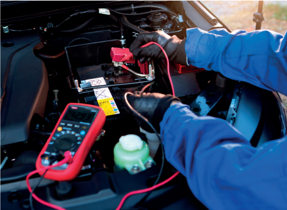
الشكل 4.30 ارتداء ملابس العمل والقفازات العازلة لفحص بطارية 12 فولت في السيارة.
