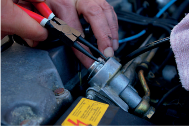
الشكل 4.39 استخدام زردية حلقات الزنق لربط حلقة الزنق بالعمود.
