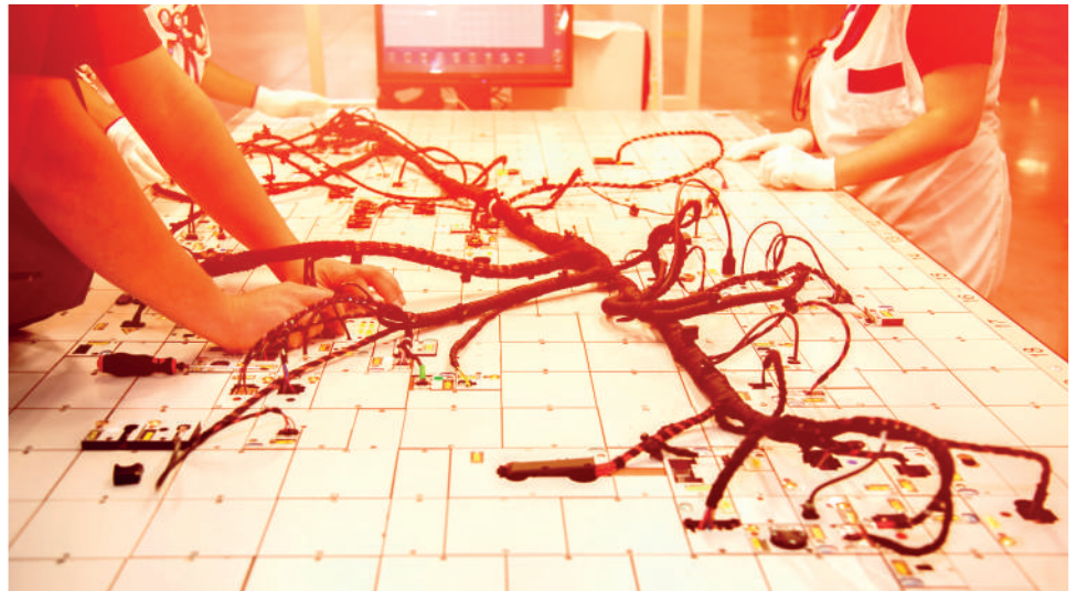
■ الشكل 4.35 فحص مجموعة أسلاك السيارة (الضفيرة) باستخدام لوحة فحص.
