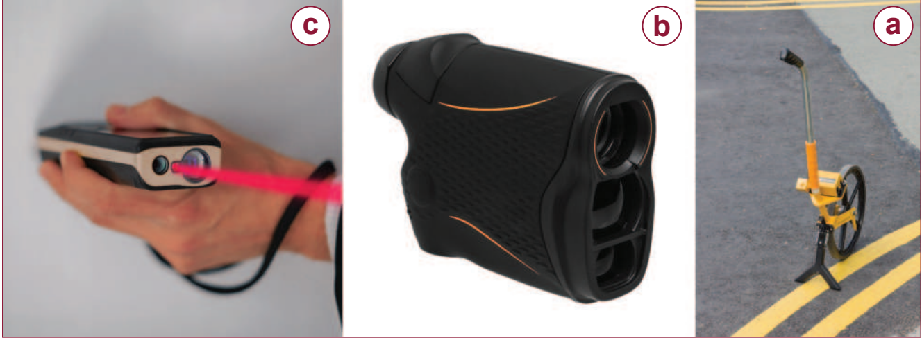
الشكل 5-17 عجلة التدحرج (a)، جهاز تحديد المدى البصري (b)، جهاز تحديد المدى الليزري (c).
