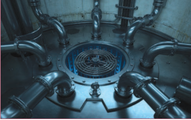
الشكل 9-17 هيكل المفاعل يصبح مُشعاً بسبب النيوترونات.
