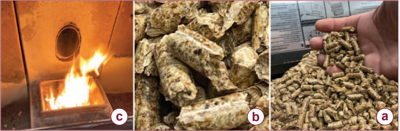
الشكل 6-7 (a) وقود الحبيبات الخشبية، (b) نظرة عن قرب لهذا الوقود، (c) وعاء يحرق هذه الحبيبات الخشبية.
