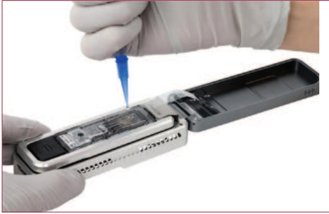
الشكل 7-16 جهاز تحديد تسلسل RNA/DNA.
