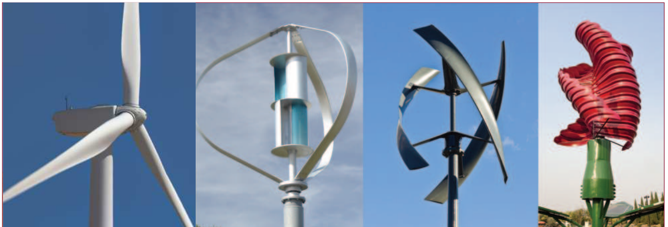
الشكل 8-13 توربينات الرياح ذات المحور الرأسي باستخدام كل من الأجنحة وتصميم سافينوس الشائع.
