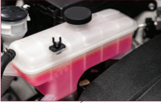
الشكل 9-2 خزان تمدد الماء في السيارة.
