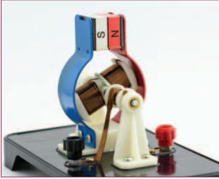
الشكل 4-8 مولّد كهربائي بسيط.
