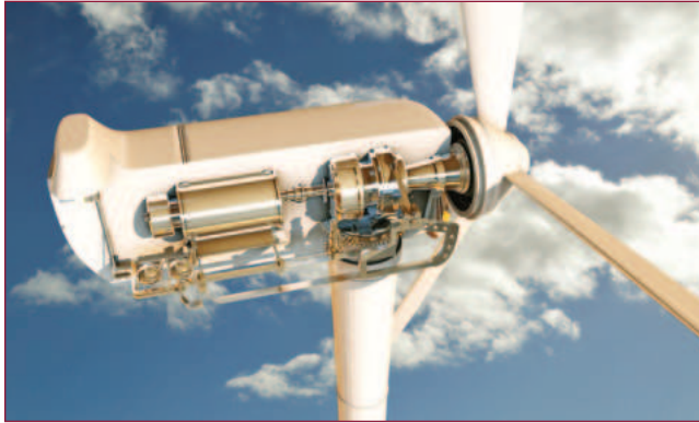
الشكل 8-12 مولّد طاقة كهربائية بواسطة الرياح باستخدام التوربين ذات المحور الأفقي.
