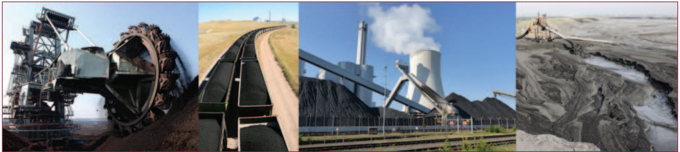
الشكل 8-19 أعمال الحفر والنقل والمعالجة والتخلص من نفايات الفحم.
