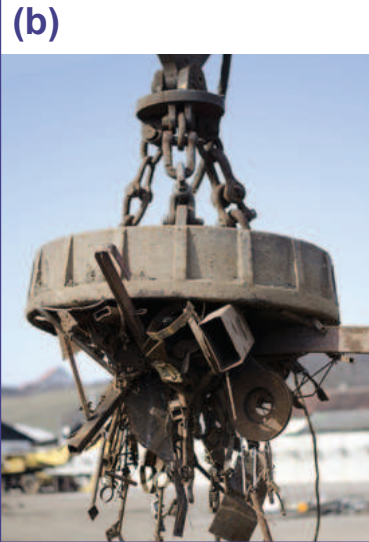
الشكل 2-6 (a) مغناطيس كهربائي بسيط، (b) مغناطيس كهربائي كبير.
