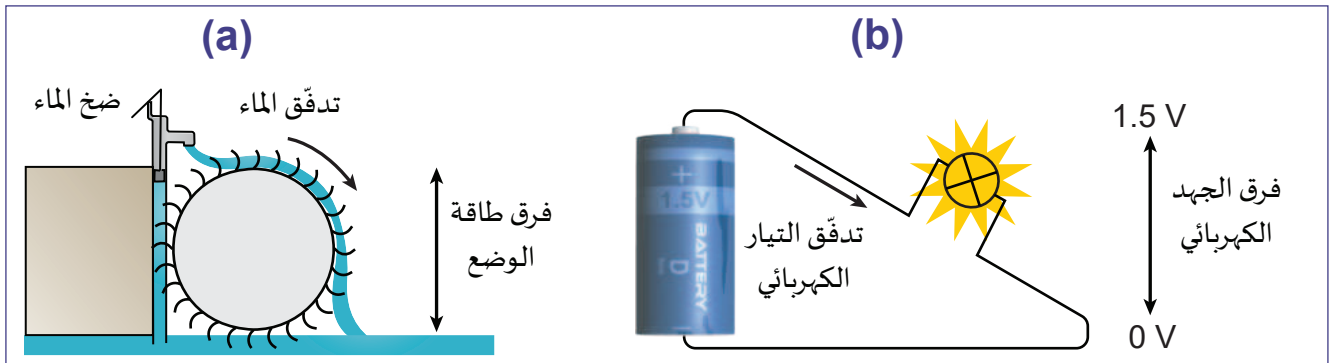
الشكل 5-8 (a) يُسبب فرق طاقة الوضع تدفقًا للماء، (b) يُسبب فرق الجهد الكهربائي تدفقًا للتيار الكهربائي.
