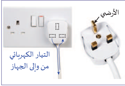
الشكل 5-5 نحصل على الدائرة الكهربائية المغلقة عند وضع قابس الجهاز في المقبس وتشغيله.
